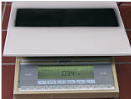
Abb. 2 Auswiegen der Fliese mit Testschmutz.
