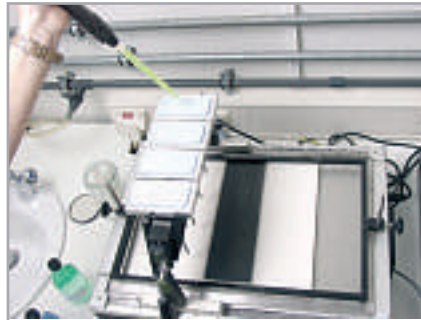
Abb. 3 Auftragen der Testreiniger.
