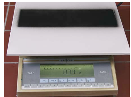
Abb. 2 Auswiegen der Fliese mit Testschmutz. (Quelle: Werner & Mertz GmbH, Mainz)
