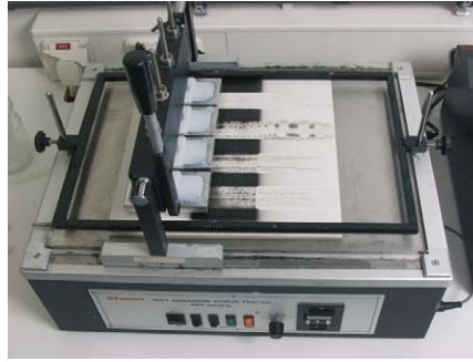
Abb.4 Testapparat während des Wischvorgangs. (Quelle: Werner & Mertz GmbH, Mainz)
